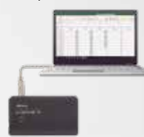
U-WAVE-R Jednostka odbioru danych
